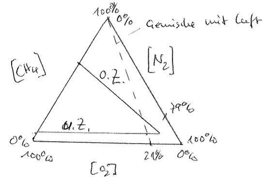
Zündgrenzen primär Energiebilanz: Erreichen von  $T_z$  als Bilanz von Reaktionswärmeabsetzung und Wärmekapazität. U.Z.  $\neq f(O_2)$  weil Wärmeabsetzung Brst. limitiert und  $\tilde{c}_{p,O_2} \approx \tilde{c}_{p,N_2}$ . O.Z. = Wärmeabsetzung  $\sim [O_2] \Rightarrow$  lin. Zus. mit  $[O_2]$ .
