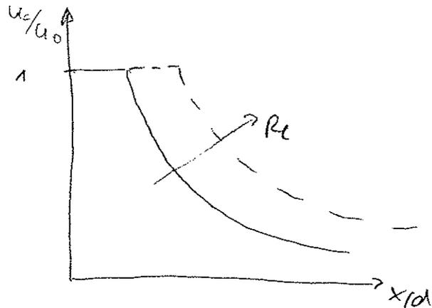
7. Was ist das besondere Kennzeichen des turbulenten Freistrahles? Geben Sie das Geschwindigkeitsgesetz  $u_c/u_0 = f(x/d)$  der Axialgeschwindigkeit auf der Achse an.
