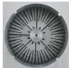
Abbildung 3: a) Axialdiffusorversuchsstand mit Messebenen S1 – S5; b) Widerstandskörper für b) gehäuselastiges und b) nabenlastiges Profil
