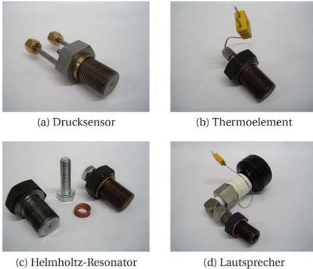
Abbildung 2: Sensoren und sonstige Einbauten
