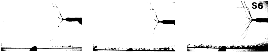
Abb. 13: Siedebeginn (a, b) und stationäres Blasensieden (c) bei Erdbedingungen.
