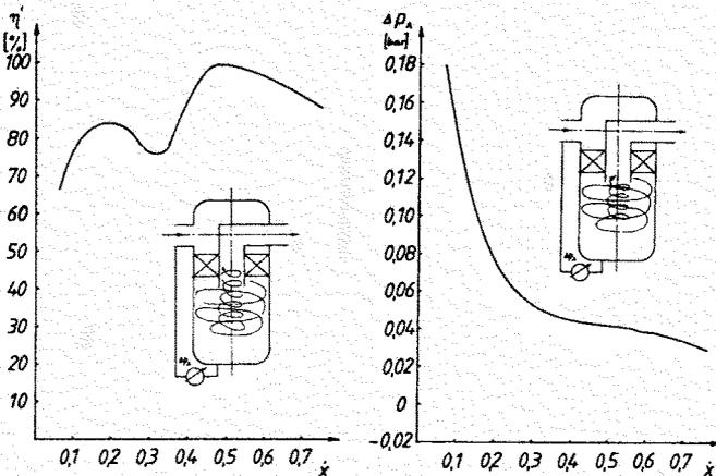
Bild 9: Abscheidegrad (links) und Druckdifferenz (rechts) eines BZ-Abscheiders
