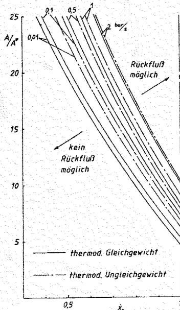
Bild 13: Berechneter Strömungszustand in der Abscheideeinrichtung beim Einsetzen der Wiedereinspeicherung der separierten Flüssigkeit in den Kessel
