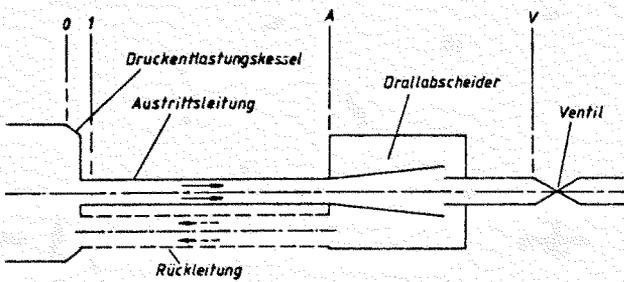
Bild 12: Einteilung der Abscheideeinrichtung in Berechnungssektoren
