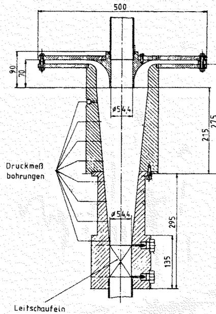
Bild 5: Konstruktionszeichnung des optimierten und in eine Druckentlastungsanlage eingebauten Drallabscheiders
