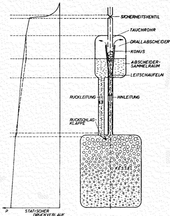
Bild 4: Druckverlauf in einer kesselinternen Abscheideeinrichtung
