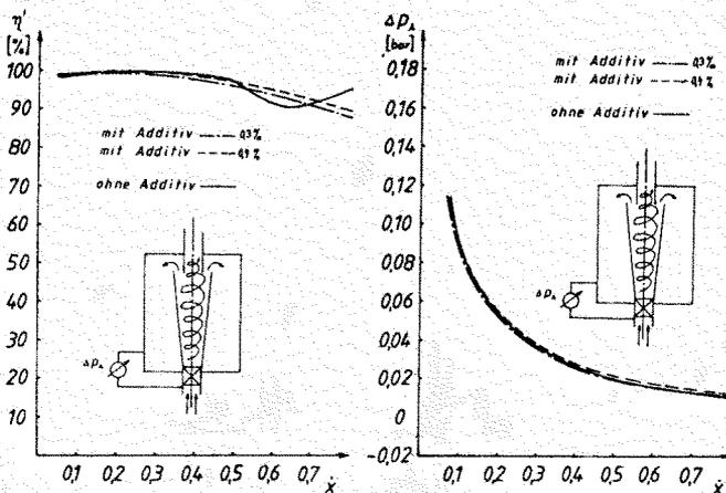
Bild 8: Abscheidegrad (links) und Druckdifferenz (rechts) eines optimierten Drallabscheiders
