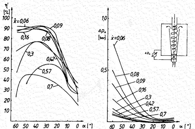
Bild 7: Abscheidegrad (links) und Druck (rechts) eines Drallabscheiders mit variablen Leitschaukeln
