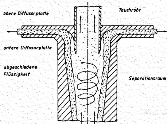
Bild 6: Drallabscheider mit Radialdiffusor zur Verzögerung des separierten Flüssigkeitsmengenstromes
