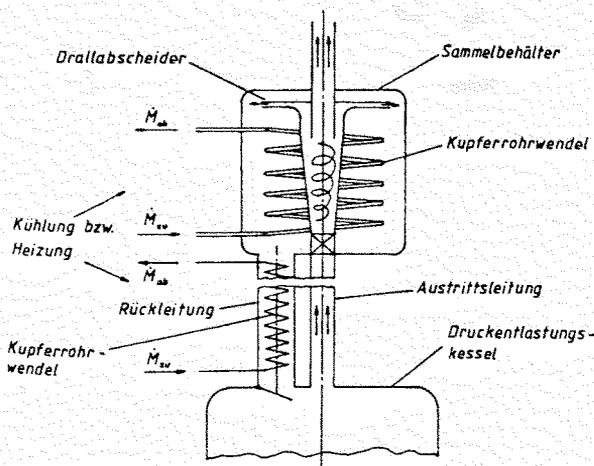
Bild 14: Gekühlte Massen im Sammelbehälter und der Rückleitung
