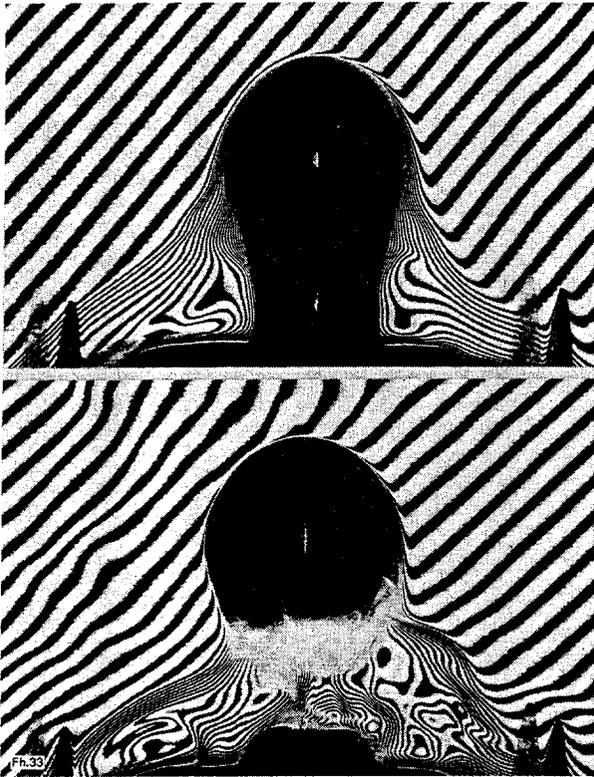
Bild 33. Temperaturfeld an einer Blase vor und nach dem Ablösen.
