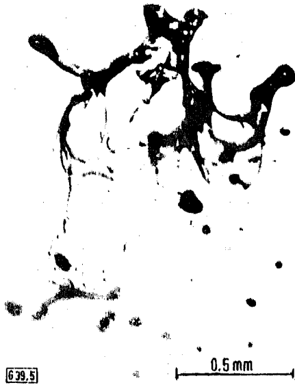
Fig. 4. Parachute like sheet (zone "1"). \tau_2 - \tau_1 = 10^{-5} \text{ s}
