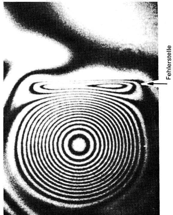
Bild 6. Interferenzstruktur der durch den Pendelstoß verformten 4 mm dicken Platte etwa 11  $\mu$ s nach dem Stoß.
