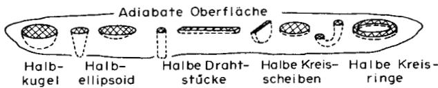
BILD 4. Halbkörper im halbbunendlich ausgedehnten Medium mit adiabater Oberfläche.
