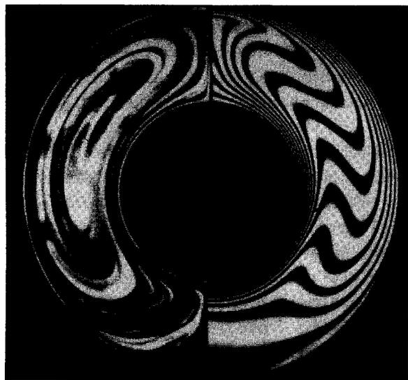
Bild 11: Natürliche Konvektion im horizontalen zylindrischen Ringspalt in Luft. Linkes Stromlinienbild durch Raucheinblasung sichtbar gemacht, rechtes Isothermenbild im Interferogramm der zur vertikalen Achse streng symmetrischen Strömung. Im unteren Staupunktsbereich des beheizten Innenzylinders hoher Temperaturgradient und Wärmeübergang ( $\Delta T = 15,6 \text{ K}$ ,  $\delta/d_i = 0,5$ ,  $\delta = 33 \text{ mm}$ ,  $\delta = (d_a - d_i)/2$ )
