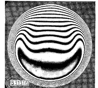
Abb. 5 (links). Mantelbeheizter horizontaler Behälter (nach 35 s.).
