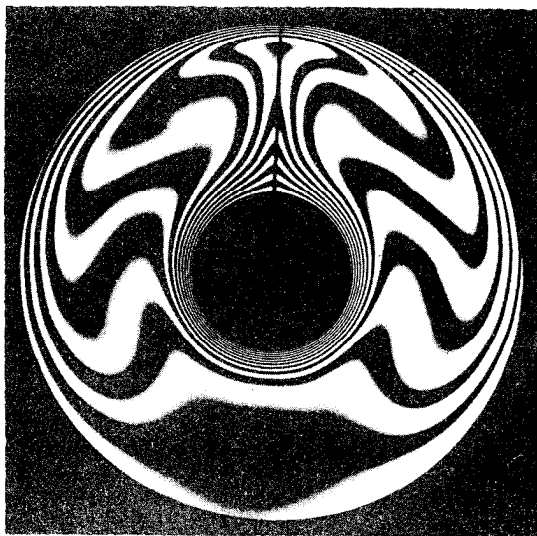
Bild 26. Interferenzbild bei völlig entwickelter Konvektion. Gr_{\delta} = 1,22 \cdot 10^5 ; \Delta\vartheta = 13 grad; \delta/d_i = 1,8
