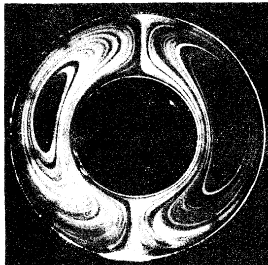
Bild 23. Stromlinienbild bei völlig entwickelter Konvektion. Gr_{\delta} = 1,2 \cdot 10^4 ; \Delta\vartheta = 3 grad; \delta/d_i = 0,5
