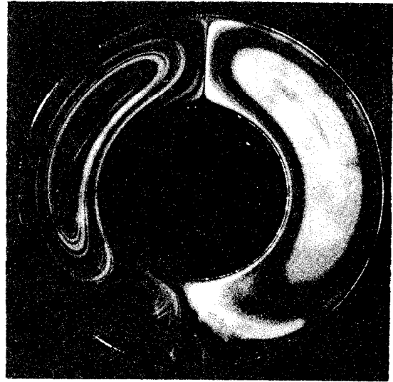
Bild 25. Stromlinienbild bei völlig entwickelter Konvektion. Gr_{\delta} = 1,2 \cdot 10^5 ; \Delta\vartheta = 14,5 grad; \delta/d_i = 1,8
