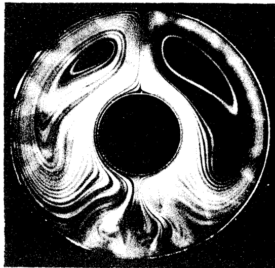
Bild 27. Stromlinienbild bei völlig entwickelter Konvektion. Gr_{\delta} = 1,2 \cdot 10^5 ; \Delta\vartheta = 14,5 grad; \delta/d_i = 1,0
