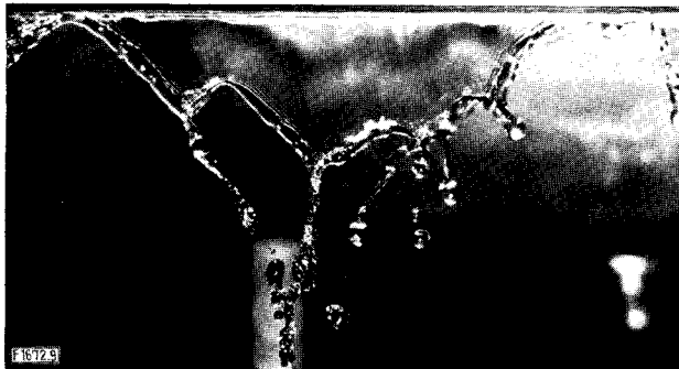
Bild 9. Flüssigkeitsfilm mit girlandenartigen Begrenzungen beim Ablauf von Äthylalkohol in Luft.
