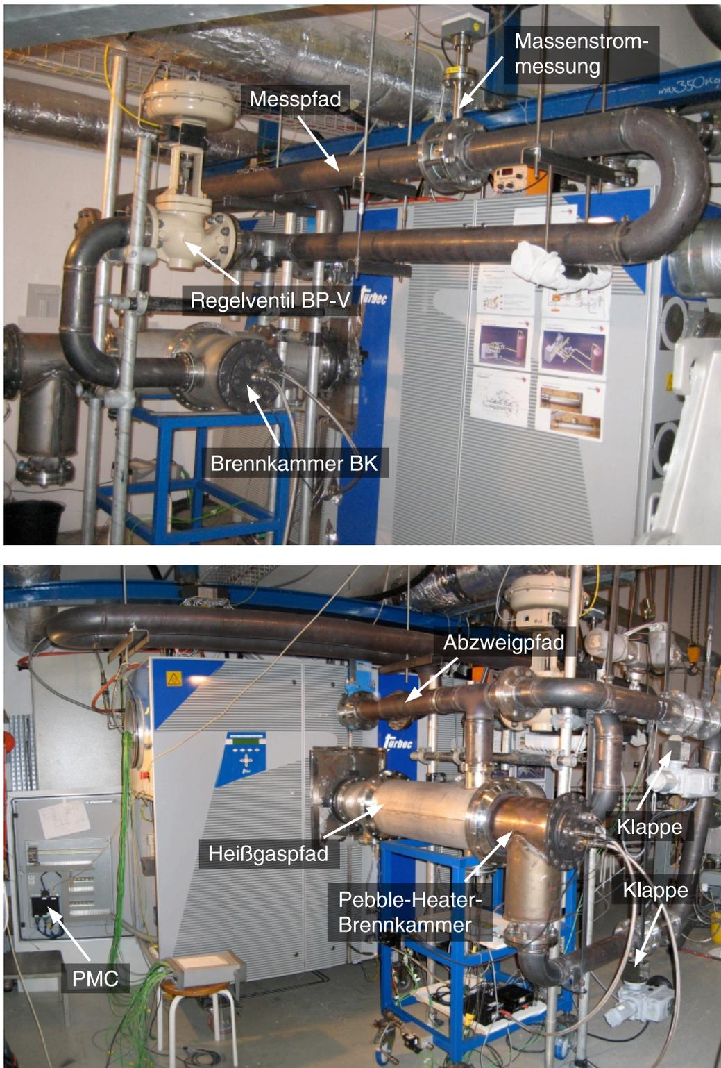
**Abbildung 3.10:** Fotos der Laboranlage. Oben: Blick von der Abgasseite; unten: Komplett installiert, mit allen Komponenten.
