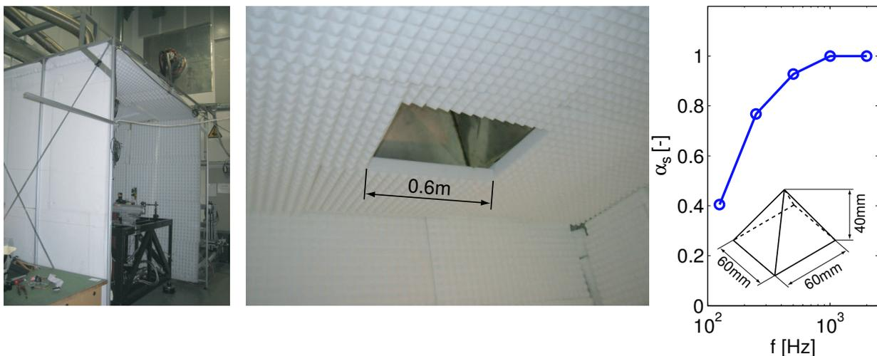
**Abbildung 3.4:** Geöffnete Akustikzelle (links). Schalldämpfmatten mit Aussparung für den Abzug (mitte) und frequenzabhängiger Absorptionsgrad  $\alpha_s$  der Matten (rechts).
