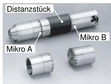
**Abbildung 5.13:** *Intensitätssonde bestehend aus zwei Mikrofonen und Distanzstück.*
