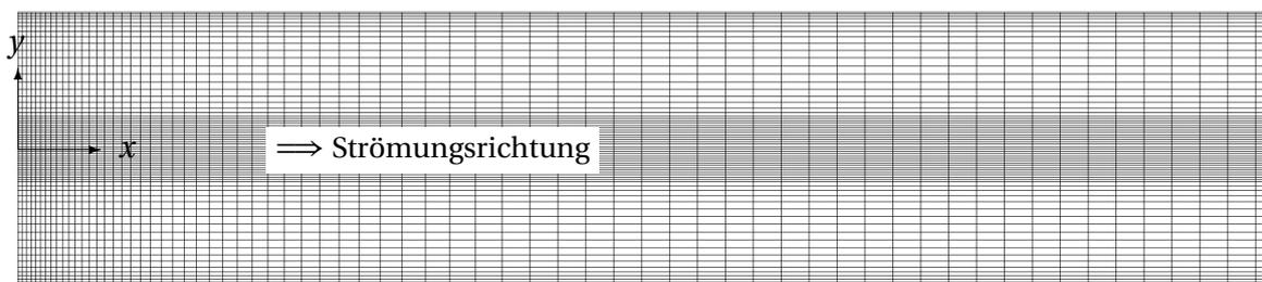
**Abbildung 3.2:** Gitter im Längsschnitt des Berechnungsgebietes
