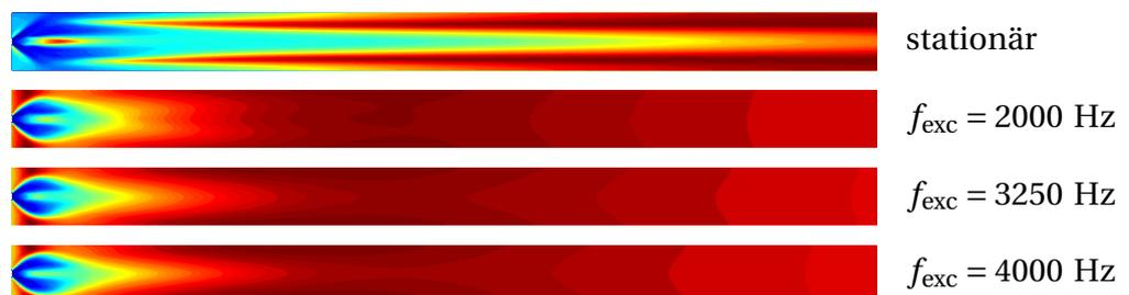
**Abbildung E.6:** Abhängigkeit des mittleren Temperaturfeldes von der Anregungsfrequenz für  $\tilde{p} = 20\%$
