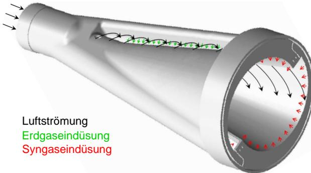
**Abb. 2.16:** EV-Brenner mit Brennstoffeindüsuingsvarianten
