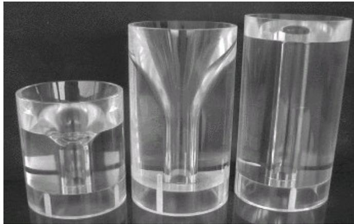
Abbildung 5.2.1: Plexiglasmodelldüsen für LDA-Strömungsmessungen
