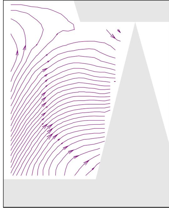
Abb. 6.1.18 b: Stromlinien: Düse
