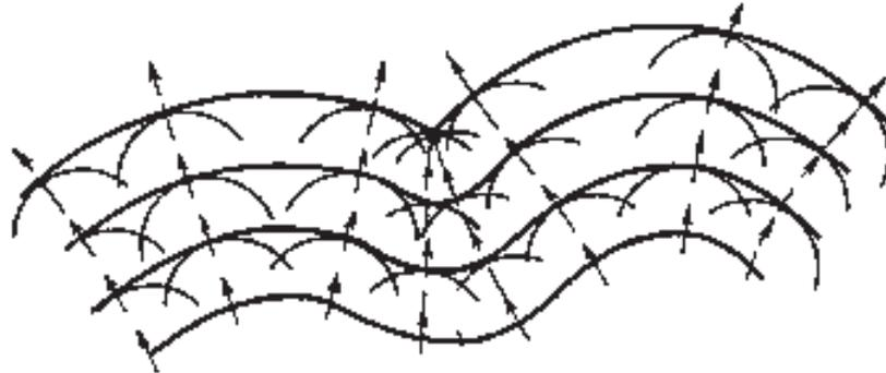
Abbildung 2.2: Ausbreitung einer laminaren Flamme unter Anwendung des von Huygenschen Prinzips.
