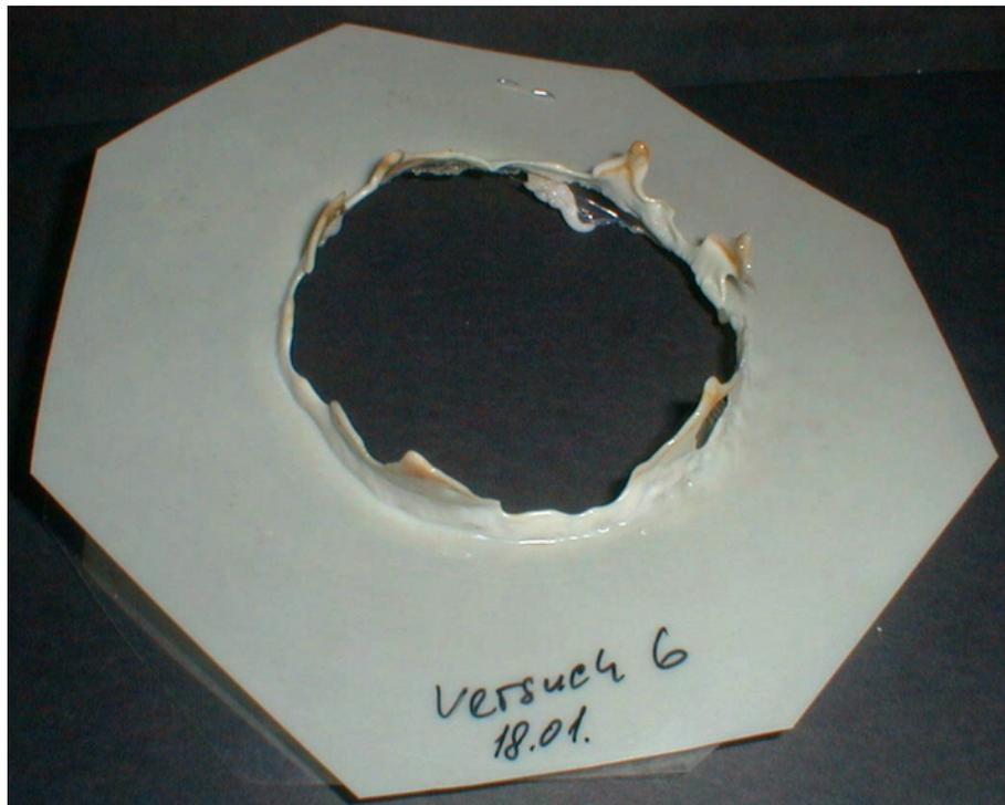
Abbildung A.1: Fotografie einer oberen Berstscheibe nach einem Heißgasversuch
