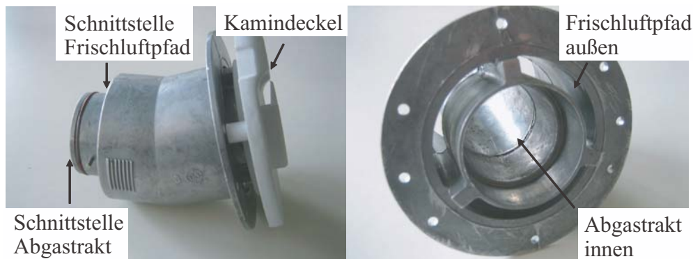
Abbildung 5.1: Ein- und Auslassstutzen der RMH. Links: seitlich mit Kamindeckel. Rechts: Strömungswege ohne Deckel.
