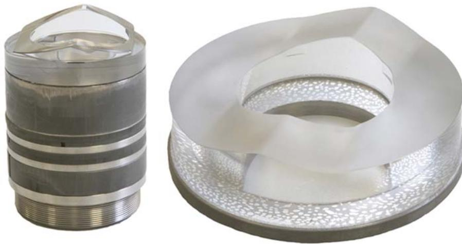
**Abbildung 3.4:** Quarzglaskolben und Ring des Transparentmotors
