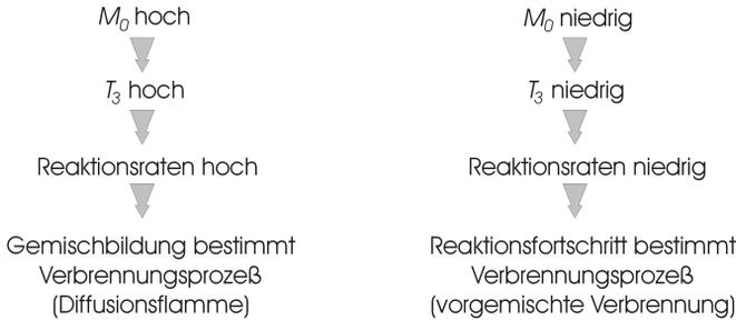
*Abb. 4-23: Abhängigkeit des Verbrennungsablaufes von den Flugbedingungen*
