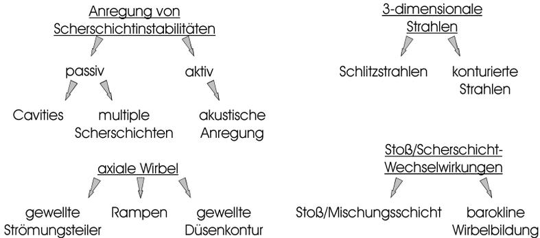
*Abb. 1-4: Überblick über Methoden zur Erhöhung der Mischungsrate von Überschallscherschichten*
