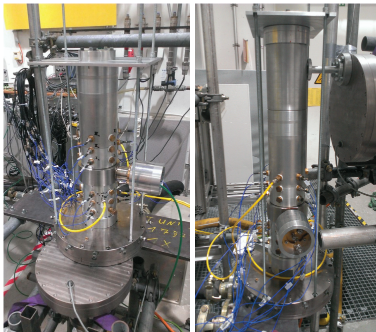
Abbildung 4.16.: Teststandkonfiguration mit radial angebrachtem Dämpfer und stromabseitiger Sirenenanregung (rechts).
