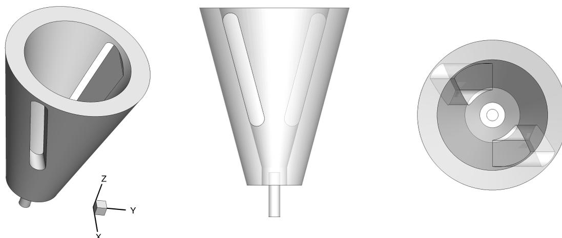
Abbildung 5.2: A<sup>2</sup>EV-Brenner mit zwei Schlitzen, Variante drei (Nr. 3 in Tab. 1.1)
