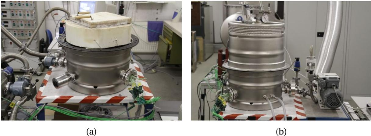
**Abbildung 4.3:** Versuchsstand zur Ermittlung der effektiven Wärmeleitfähigkeit geöffnet (a) und geschlossen (b)
