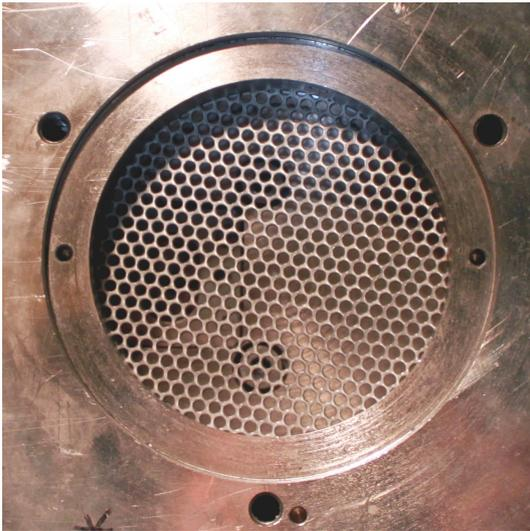
**Abbildung 4.5.:** Einströmkopf mit eingebautem Lochblech
