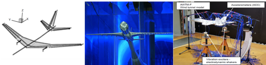
Abbildung: FERMAT Strukturmodell der CRM Konfiguration (links), XRF1 Modell im ETW in Köln (mitte) und Windkanalmodell beim GVT am Lehrstuhl (rechts)
